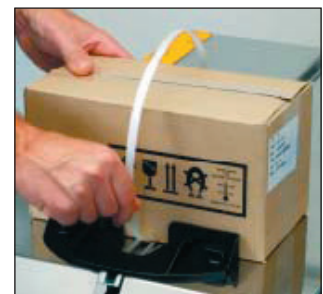
Automatische Auslösung durch Einschieben des Bandendes
